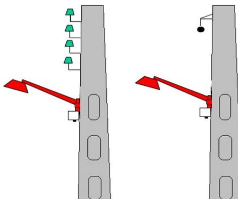
Figure 2 : Réseau électrique BT + éclairage public
